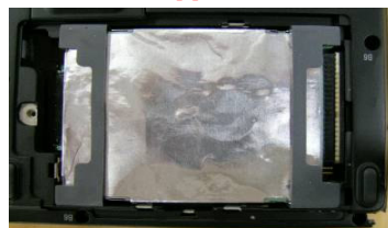
Жесткий диск окружен ударопоглощающим материалом, который действует как угловой амортизатор
